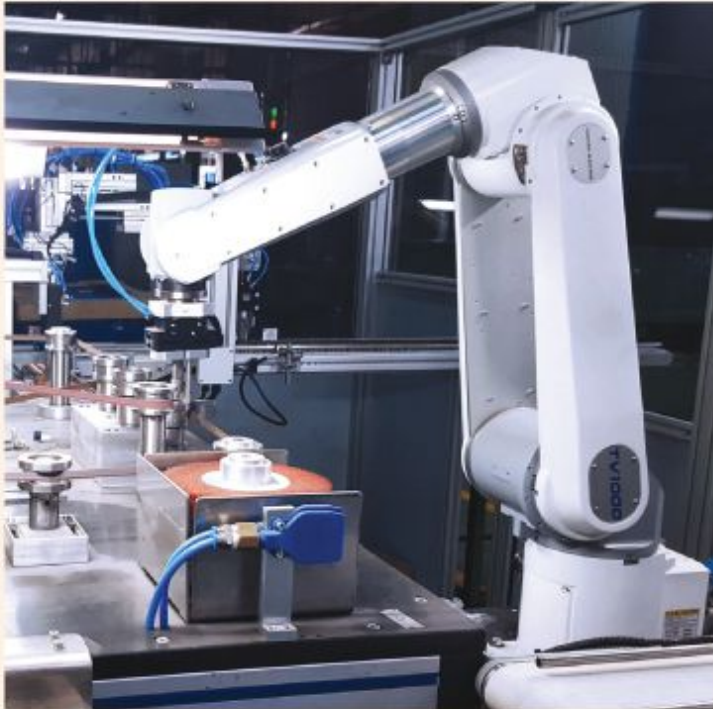
SMY tarafından geliştirilen Zımpara Robotu
